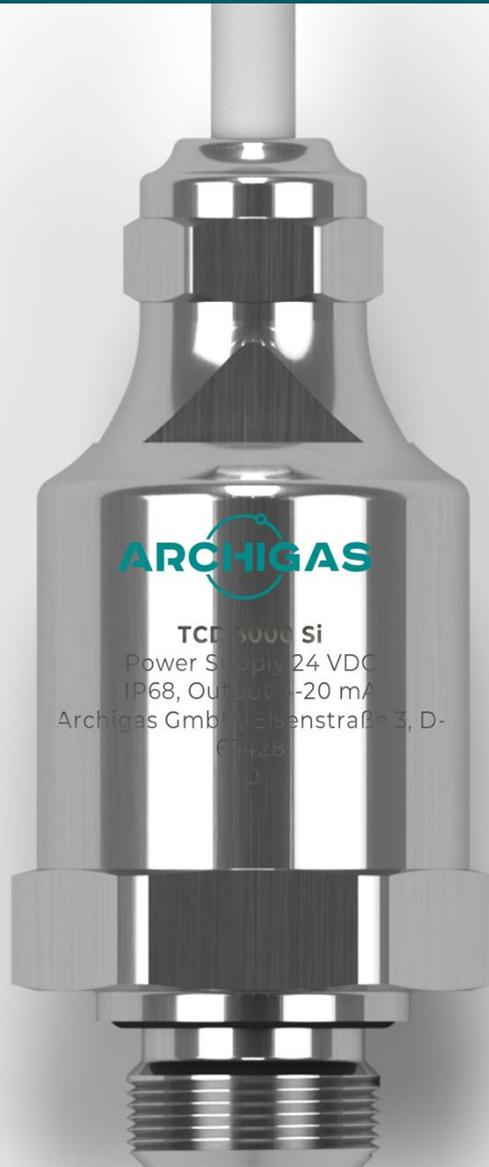
Der kompakte und robuste TCD3000 SI (Screw-In) Transmitter eignet sich hervorragend für die präzise, schnelle und empfindliche Messung von (quasi-)binären Gasgemischen. Die Messung basiert auf dem Prinzip der Wärmeleitfähigkeit. Diese Technologie ist ideal für die Messung von Gasen mit stark unterschiedlichen Wärmeleitfähigkeiten, wie zum Beispiel H<sub>2</sub> und O<sub>2</sub>.
